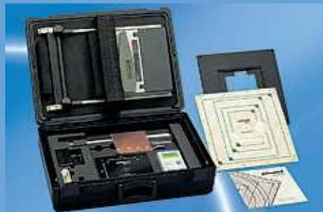
Prüfkoffer in unterschiedlicher Ausstattung zur Durchführung der Konstanzprüfungen an Röntgenanlagen für die Aufnahme sowie den dazugehörigen Filmentwicklungsmaschinen. Die Koffer enthalten alle Geräte und Hilfsmittel, die zur Durchführung der vorgeschriebenen Prüfungen erforderlich sind, z.B.:
